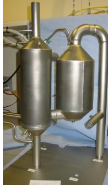
Abbildung 3.2.2-13: ProEngineer® Zeichnung der Brenner-Reformer-Einheit (links) und realer Aufbau (rechts)
