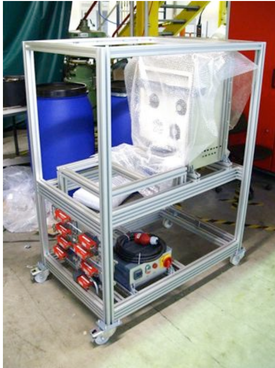
Abbildung 3.5.1-2: Gestell mit ISM und Gasversorgung
