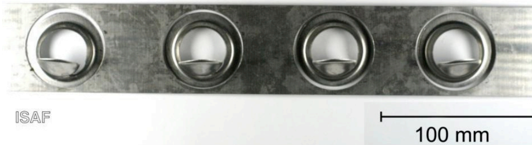
Abbildung 3.1.18: Näpfchenzugversuch bei 0,5 mm Crofer 22 APU-Blechen
