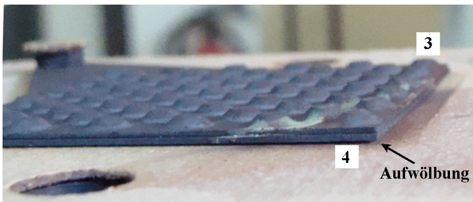
Abbildung 3.2.9: Aufwölbung des unteren Kathoden-Interkonnektors im Aufbau DZ2
