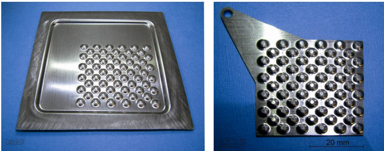
a) Abbildung 3.1.23: Rohling des umgeformten Interkonnektors mit Noppenstruktur vor (a) und nach (b) dem Laserzuschneiden und Schleifen
