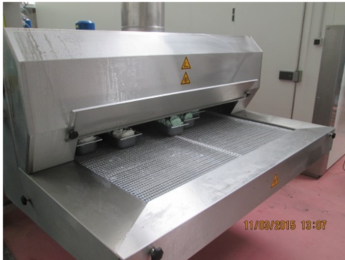
Abbildung 17: Austrittsbereich des Stickstofftunnels
