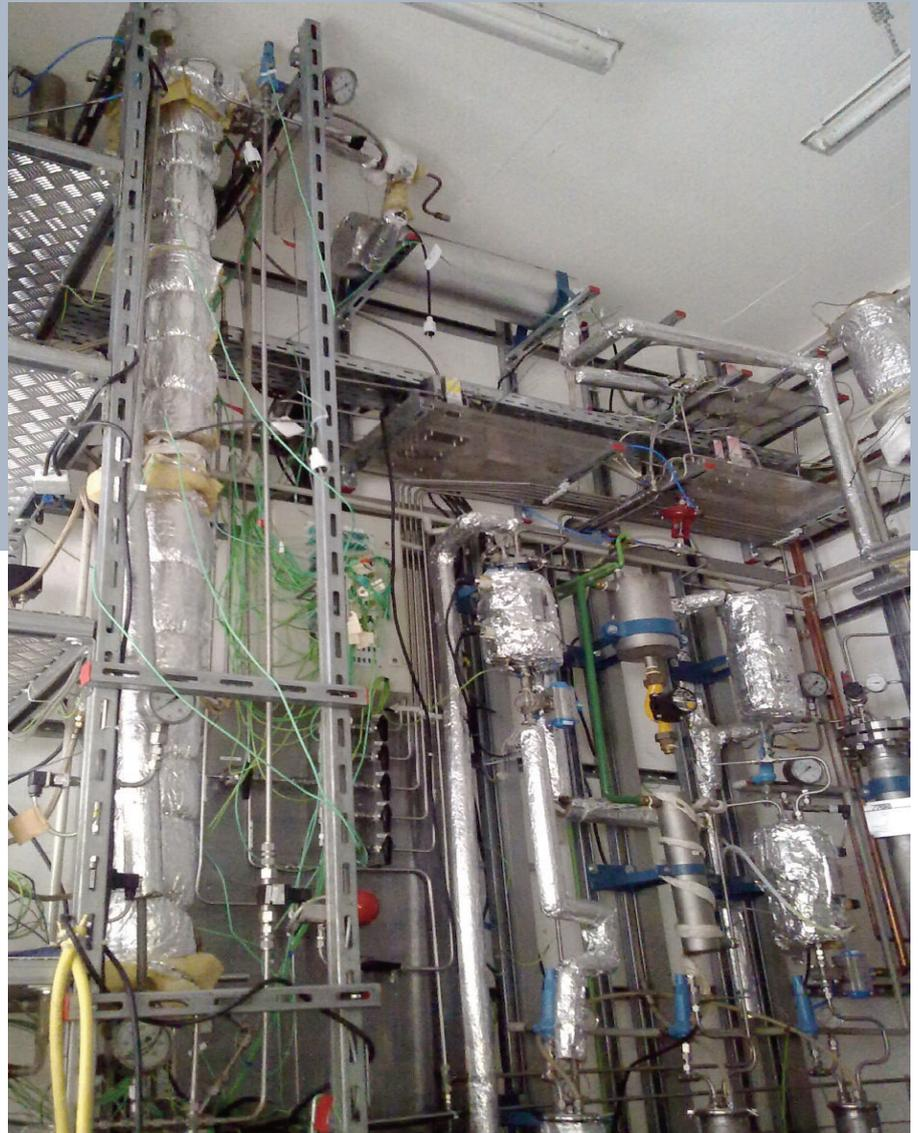
Die Fischer-Tropsch-Versuchsanlage wurde zur Untersuchung und Optimierung verfahrenstechnischer Betriebsparameter entwickelt. Darüber hinaus lassen sich Katalysatoren im Hinblick auf reaktionstechnische Größen wie Umsatz, Selektivität und Ausbeute untersuchen und miteinander vergleichen.
