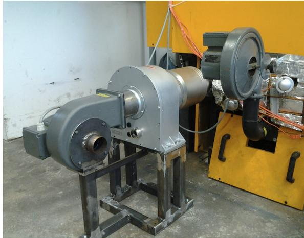
Abbildung 2-11: Lufterhitzer LHS 91 zur Sekundärluft-Vorwärmung
