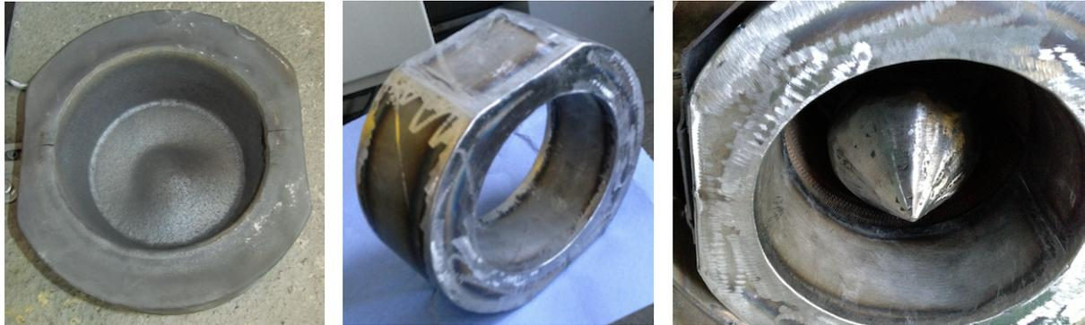
Abbildung 2-37: Prallplatte – original (links) und neu gebaut (Mitte), rechts eingesetzt im Stirlingmotor mit Erhitzer und neuem Mischer-Rohr
