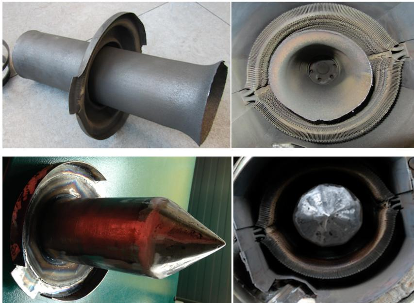
Abbildung 2-36: Mischer-Rohr – original (links oben) und neu gebaut (links unten), rechts jeweils eingesetzt im Stirlingmotor mit Erhitzer
