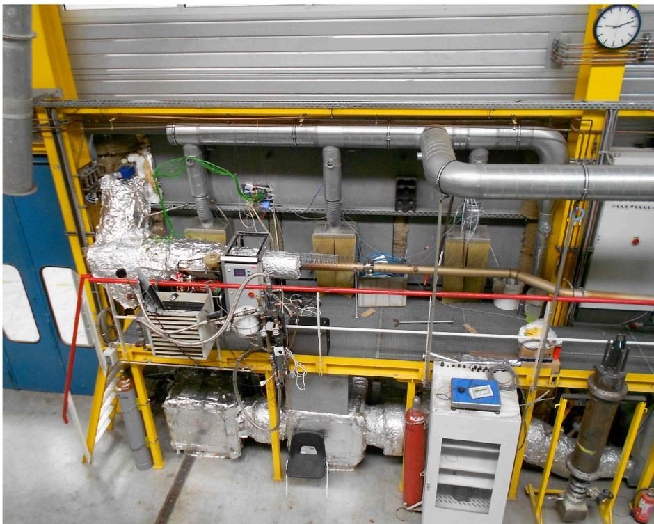
Abbildung 2-39: Aufbau des Stirlings an der RNV, von rechts Zufuhr des Heißgases
