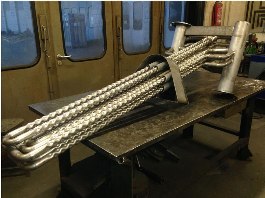
Abbildung 2-27: Gefertigter und an Deckel angepasster HTWT
