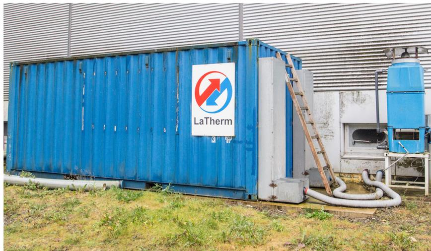
Abbildung 15: LaTherm als Latentwärmespeicher
