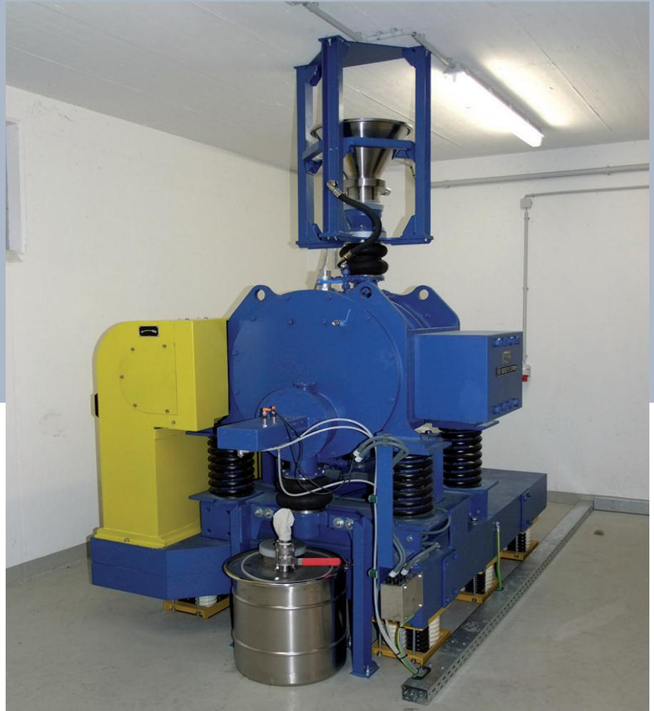
Diese erlauben ebenfalls das verwenden unterschiedlicher Auskleidungen und Mahlkörper je nach den Anforderungen der Zerkleinerungsaufgabe. Zu den weiteren Ausstattungsmerkmalen gehört unter anderem eine automatische Dosiereinheit, die auch eine semikontinuierliche Betriebsweise der Maschine, welche normalerweise im Batchbetrieb gefahren wird, erlaubt.
