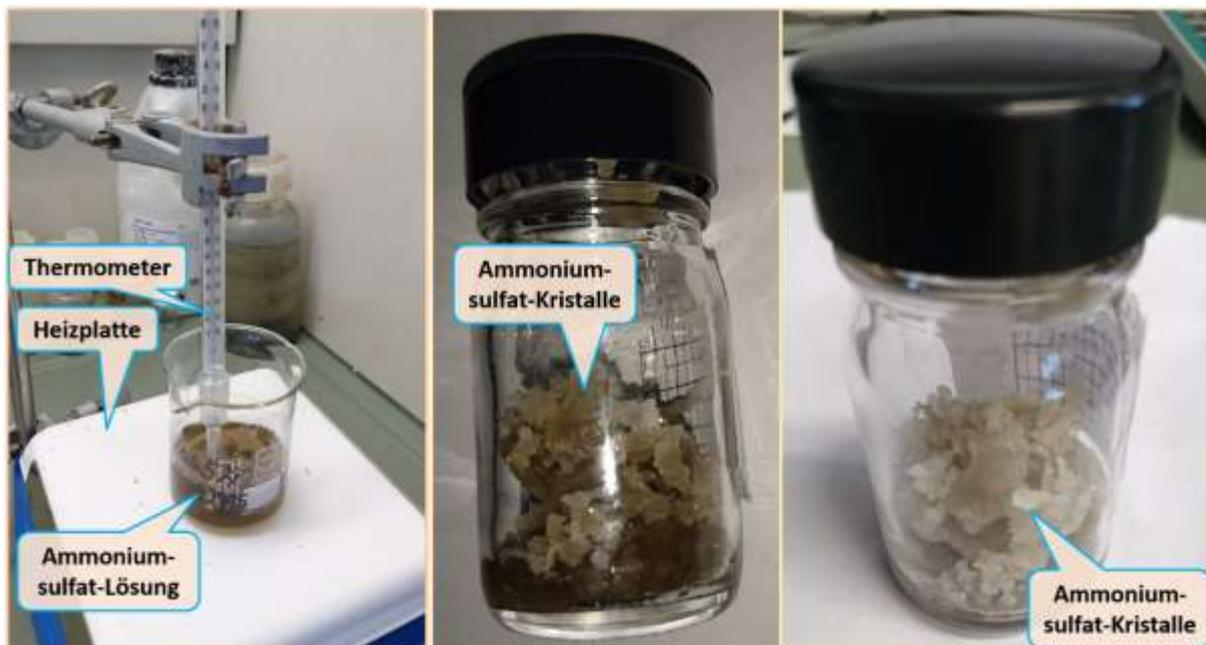
**Abbildung 3.34:** Auskristallisation des Ammoniumsulfates
