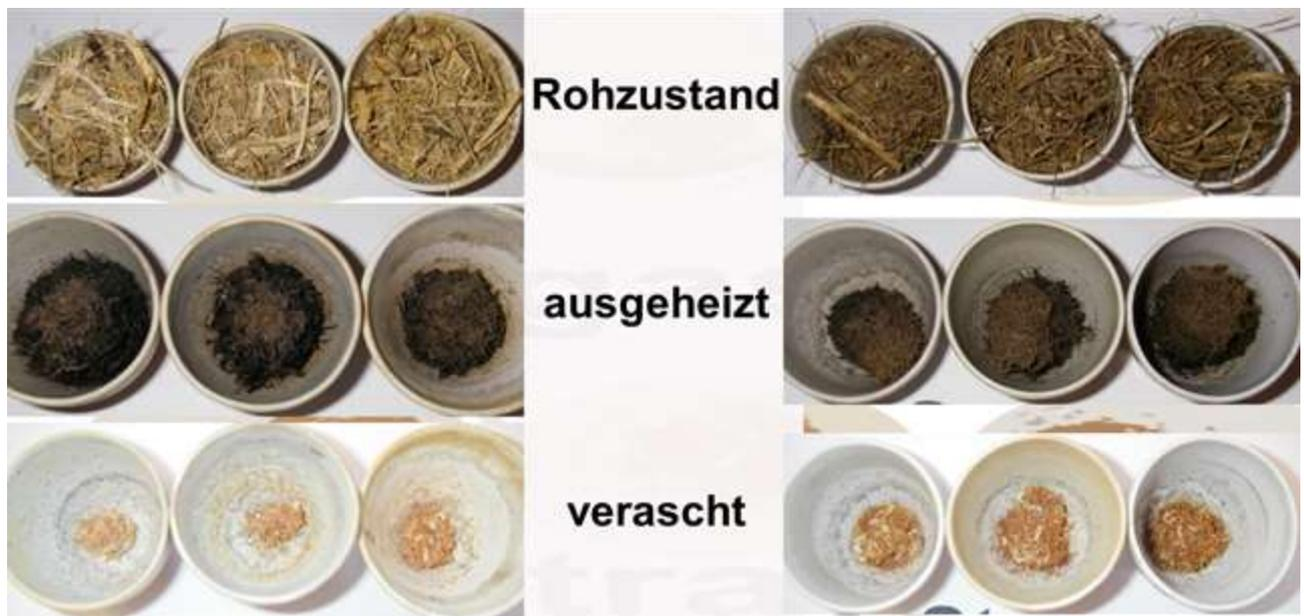
**Abbildung 3.6:** Stufen bei der Veraschung unter reduzierender Atmosphäre, Zuckerrohr-Bagasse (li.) und Zuckerrohr-Stroh (re.)
