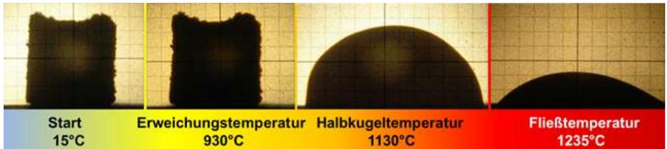
**Abbildung 3.5:** Ascheprobe im Schmelzmikroskop unter CO/CO<sub>2</sub>/H<sub>2</sub>-Atmosphäre
