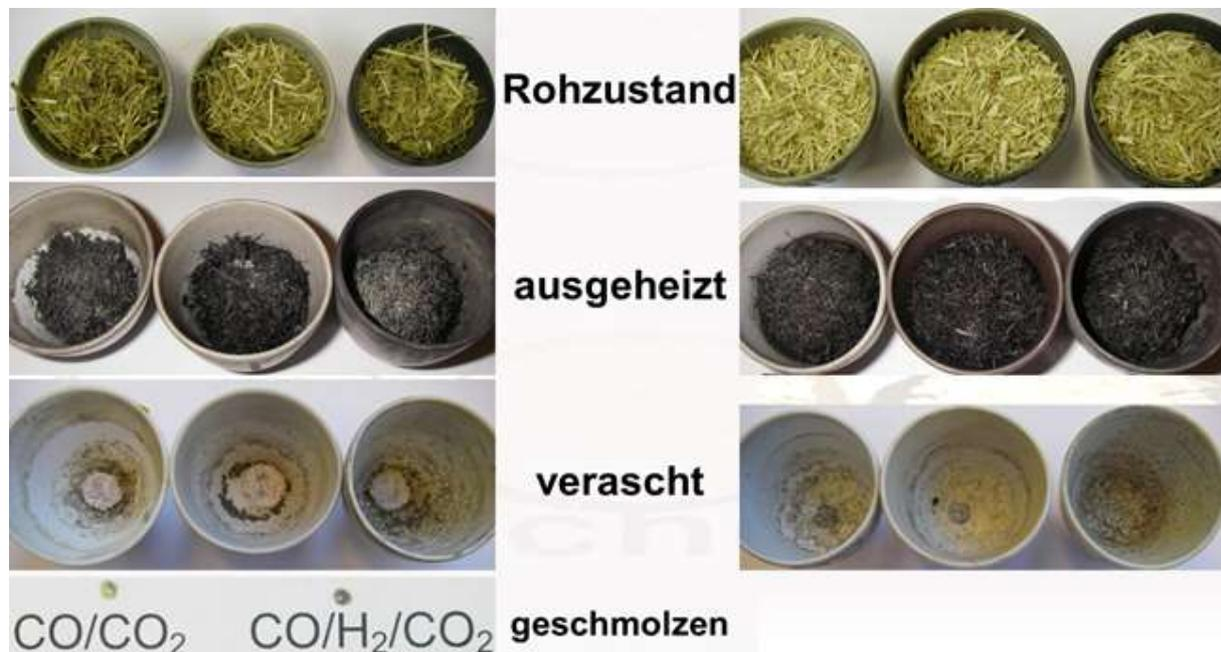
**Abbildung 3.8:** Stufen bei der Veraschung unter reduzierender Atmosphäre, Vergleichsbiomassen Switchgras (li.) und Miscanthus (re.)
