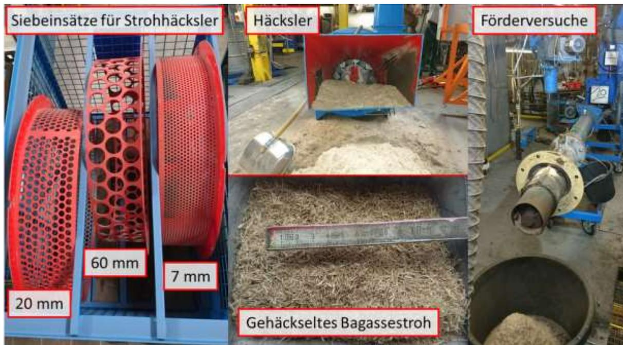
**Abbildung 3.19:** Häckselung des Bagasse-Strohs
