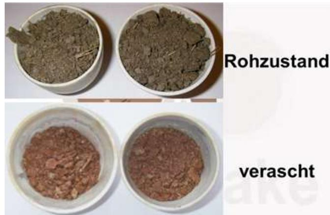
**Abbildung 3.7:** Stufen bei der Veraschung unter reduzierender Atmosphäre, Filterkuchen aus der Zuckerherstellung
