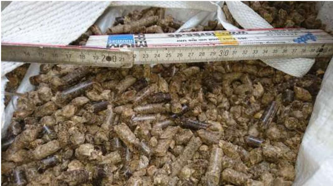
**Abbildung 3.16:** Bagasse-Pellets April 2016
