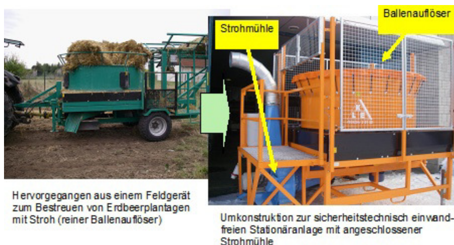
Abb. 6.5-1: Verwendeter Halmgut-Häcksler, bestehend aus Ballenauflöser und Strohmühle
