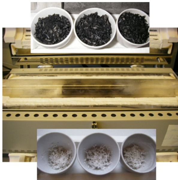
Abb. 6.3-3: Röhrenofen mit Quarzrohr und Glühtiegeln (Mitte); Getreidereststoffe bei 400°C pyrolysiert (oben) und bei 815°C mit Wasserdampf vergast (unten)
