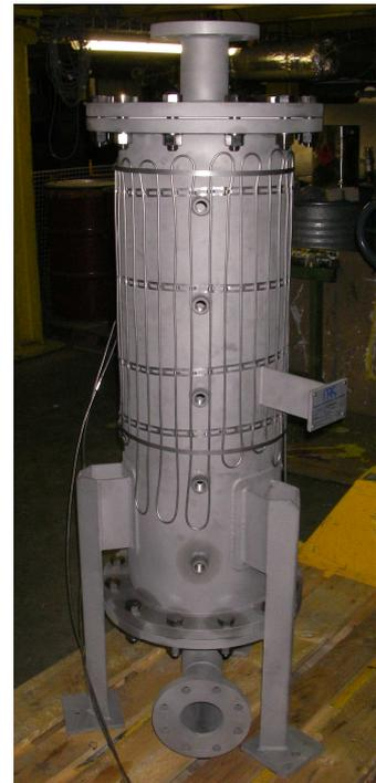
Der Reaktor wird von oben nach unten durchströmt. Die Begleitheizung bedeckt nur die oberen vier Zonen, da die Versuche im Laborreaktor zeigten, dass eine Temperaturführung im Reaktor mit geringeren Temperaturen zum Reaktorausgang günstig ist.
