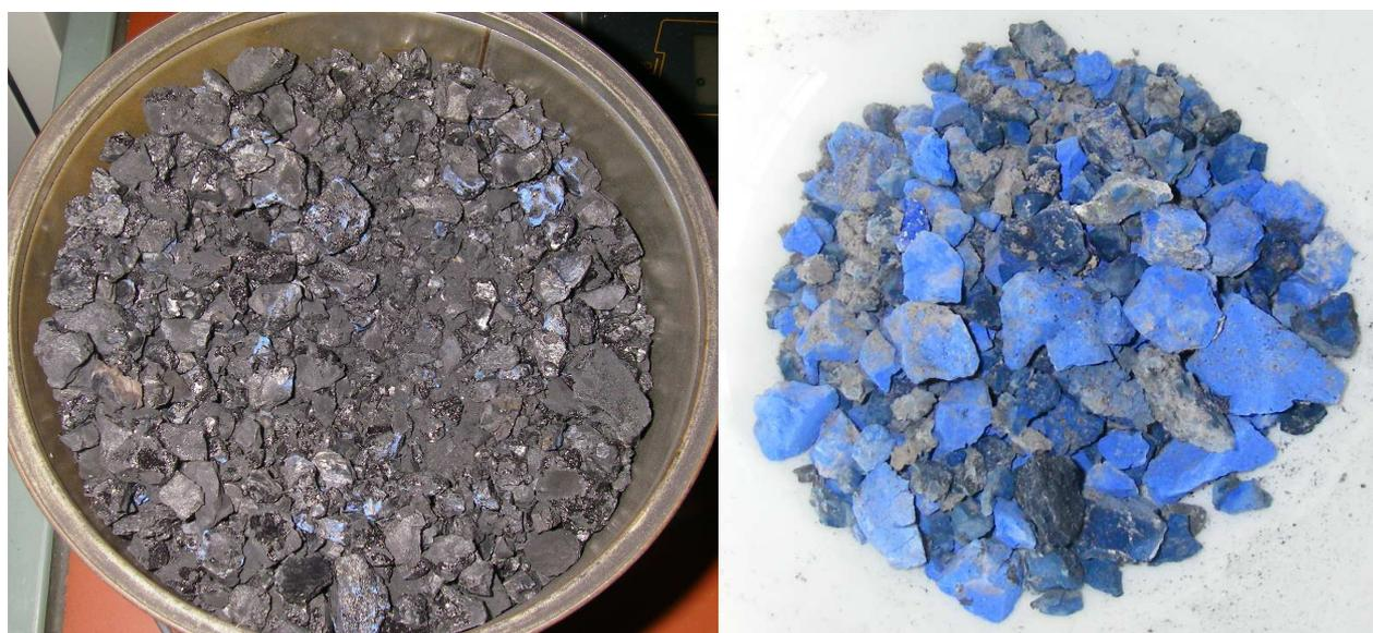
**Abb. 6.4-1:** Katalysator vor der Regeneration (links) und danach (rechts)
