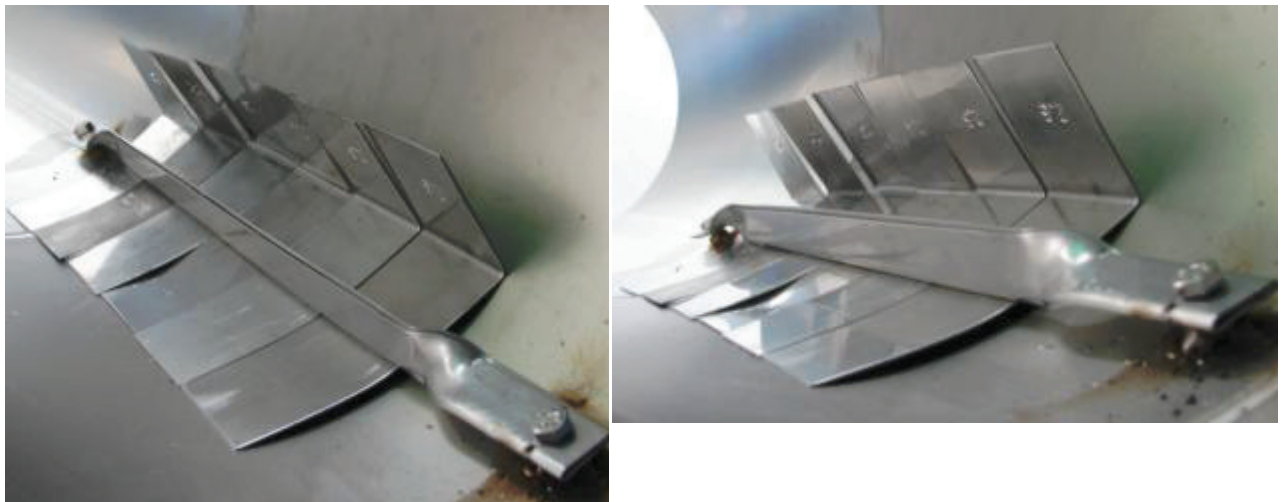
Abb. 6.2-14: Verbautes neues Blechprobenpaket 2.X im Rohgas nach Wärmeübertrager
