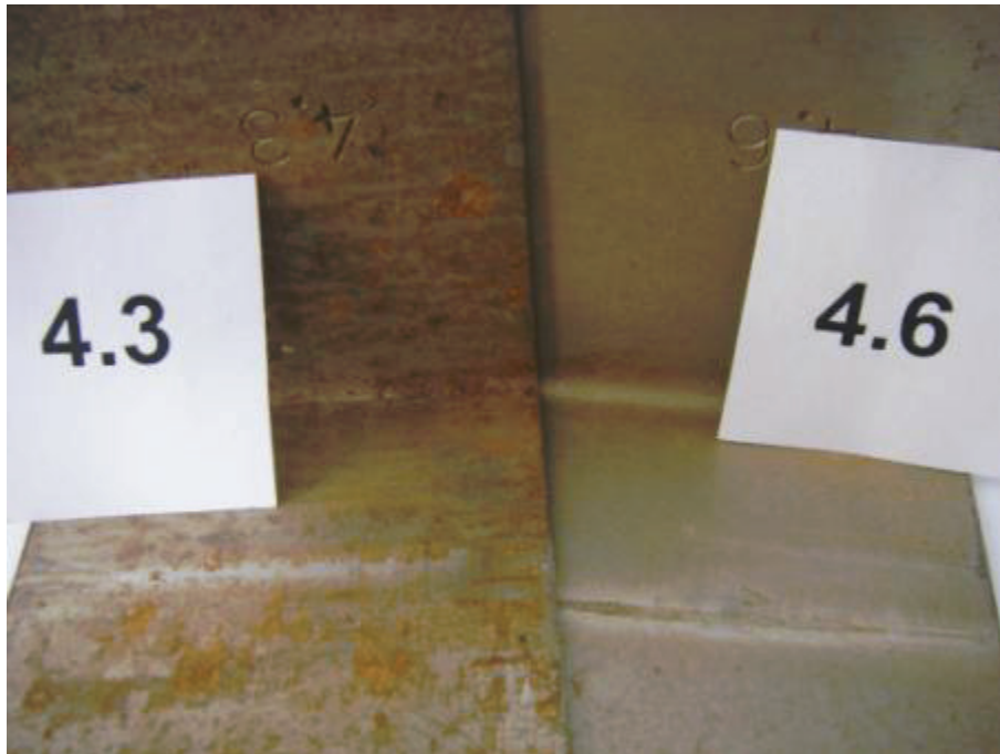
Abb. 6.2-31: Direkter Vergleich zwischen Edelstahl 1.4301 (Probe 4.3) und Edelstahl 1.4539 (Probe 4.6) aus dem kalten Reingas
