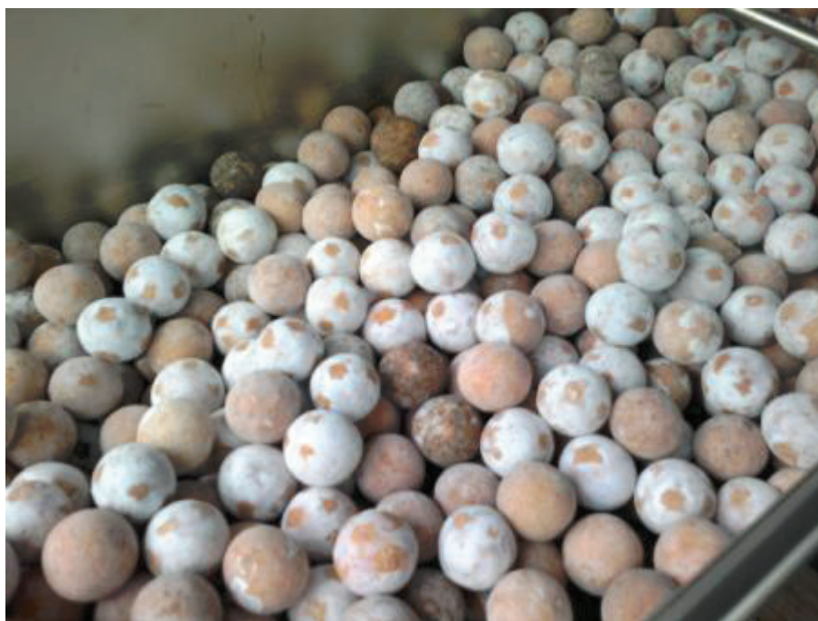
Abb. 6.2-7: Keramikugeln nach 4 Wochen Versuchsbetrieb mit weißem unkritischen Belag
