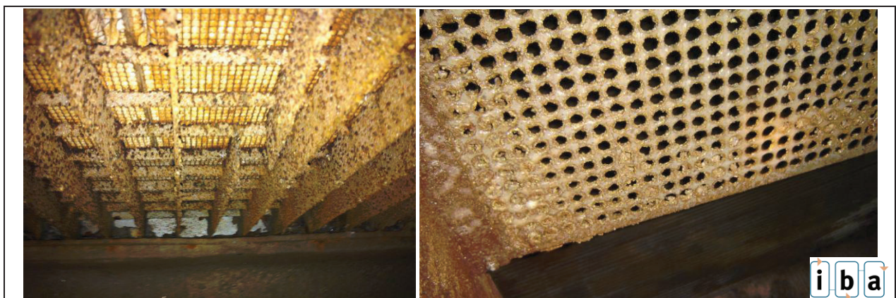
Abb. 2.2-1: Ammoniumsulfatbeläge im unteren Anströmbereich in RTOs
