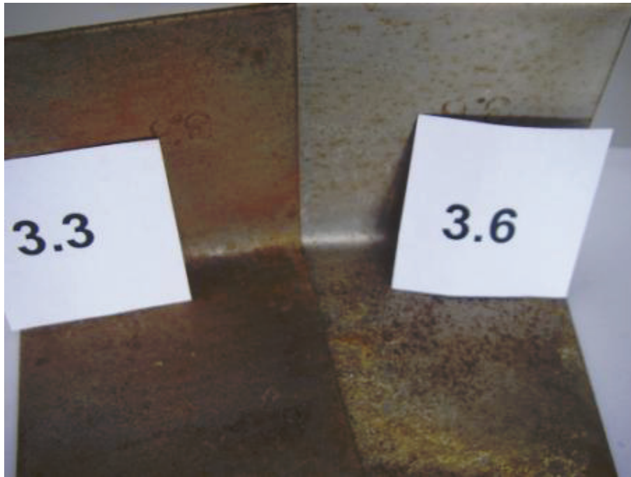
Abb. 6.2-29: Direkter Vergleich zwischen Edelstahl 1.4301 (Probe 3.3) und Edelstahl 1.4539 (Probe 3.6) aus dem warmen Reingas
