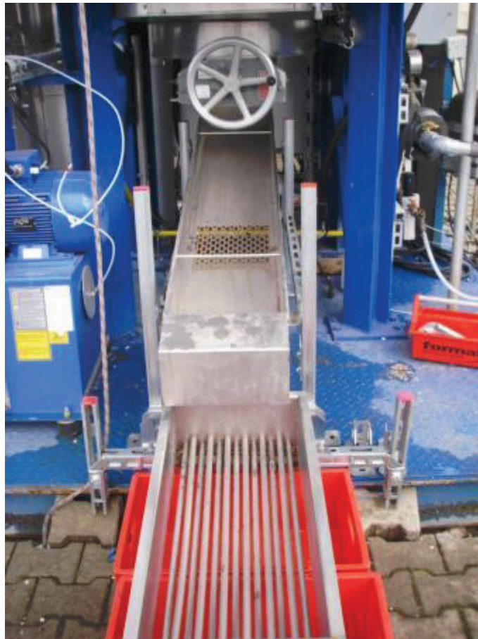
Abb. 6.2-6: Austragsystem mit Feinsieb und Stangensieb
