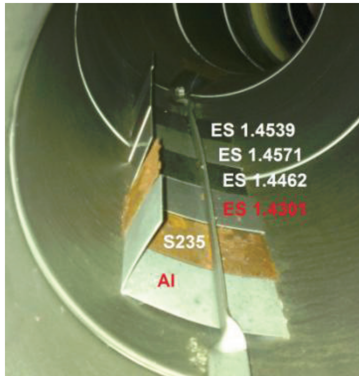
Abb. 6.2-15: Eingebaute Blechproben im Rohgas nach 4 Wochen Probebetrieb
