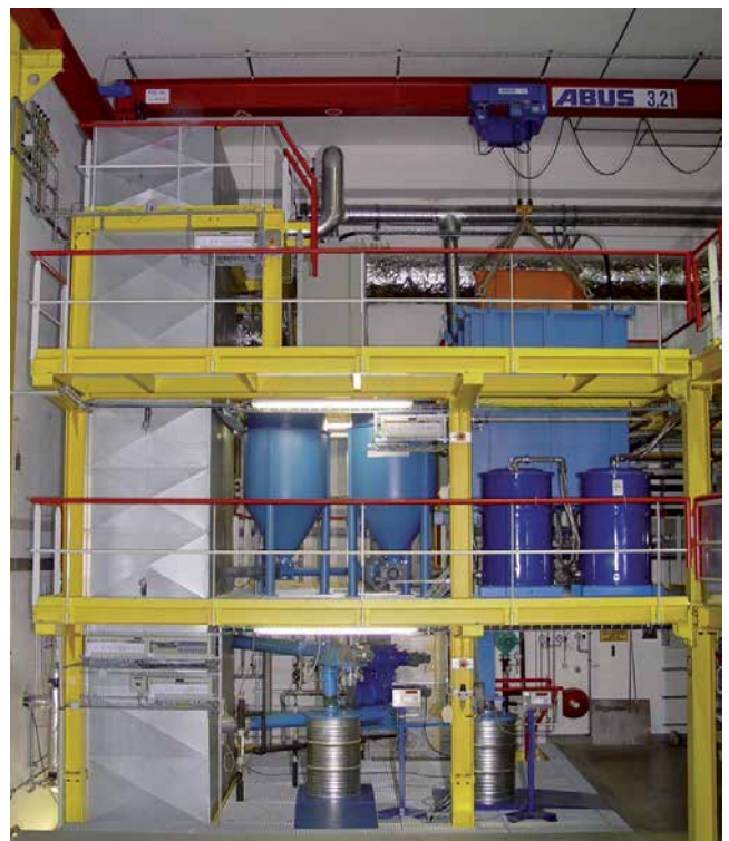
Abb. 3: Zirkulierende Wirbelschicht für Vergasung und Verbrennung, Foto: CUTEC
