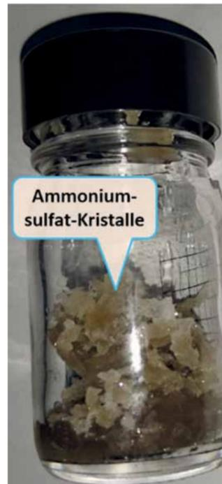
Abb. 2: Kristalle des Ammonium-sulfates, Foto: CUTEC
