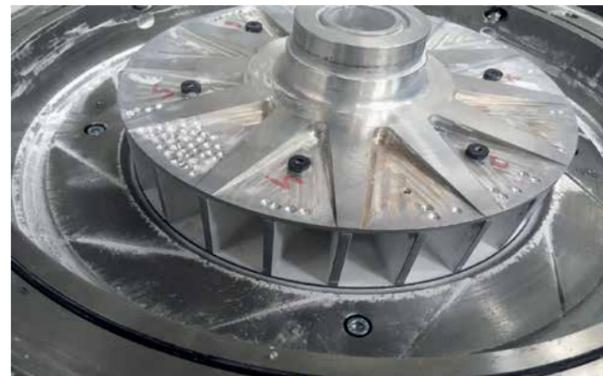
Abb. 3: Rotor des Windsichters nach den ersten Versuchen (nach Demontage der oberen Gehäuseteile), Foto: Leonard Hansen
