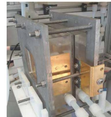
Abb. 1: Elektrochemischer Entkalkungsreaktor, Foto: Thorben Muddemann, TU Clausthal
