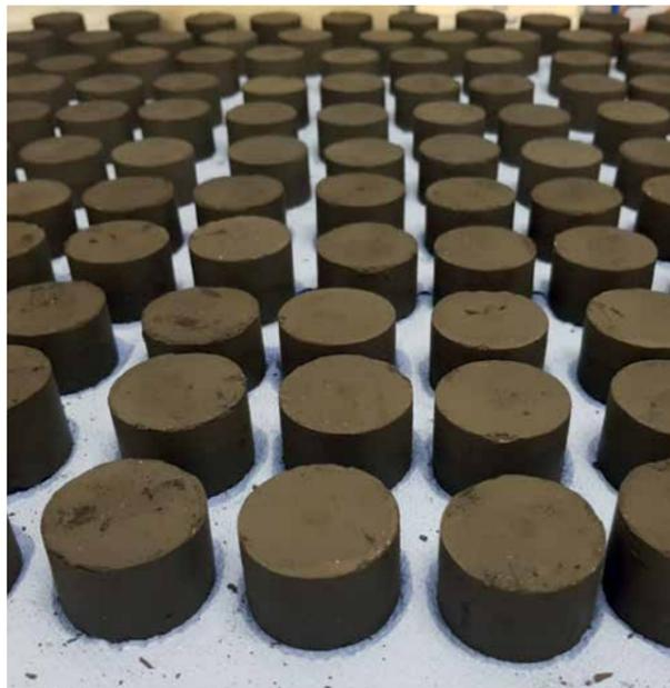
Abb. 1: Brikett-Testreihen unterschiedlicher Zusammensetzungen, Foto: CUTEC
