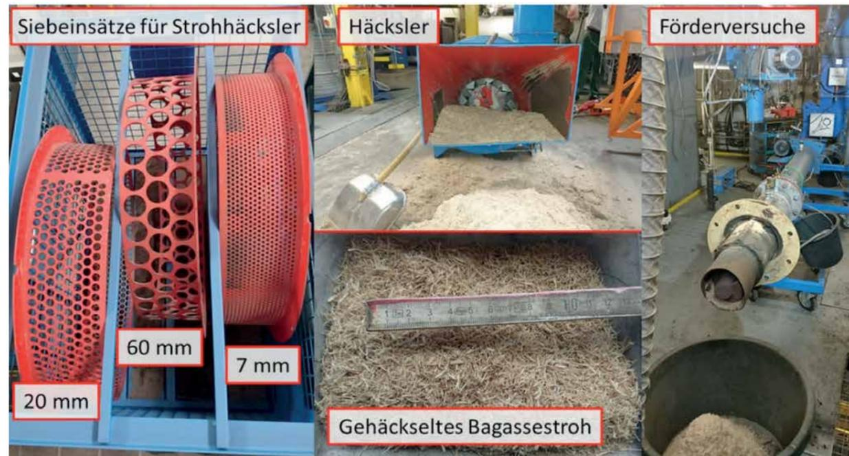
Abb. 1: Häckselung und Förderversuche mit brasilianischem Bagassestroh, Foto: CUTEC
