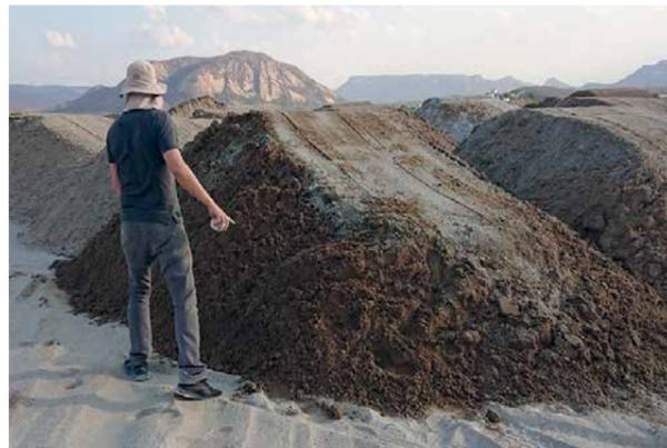
Abb. 2: : Probenahme von Tailings (Grobfraktion) für die Voruntersuchungen, Mina Brejuí 2018
