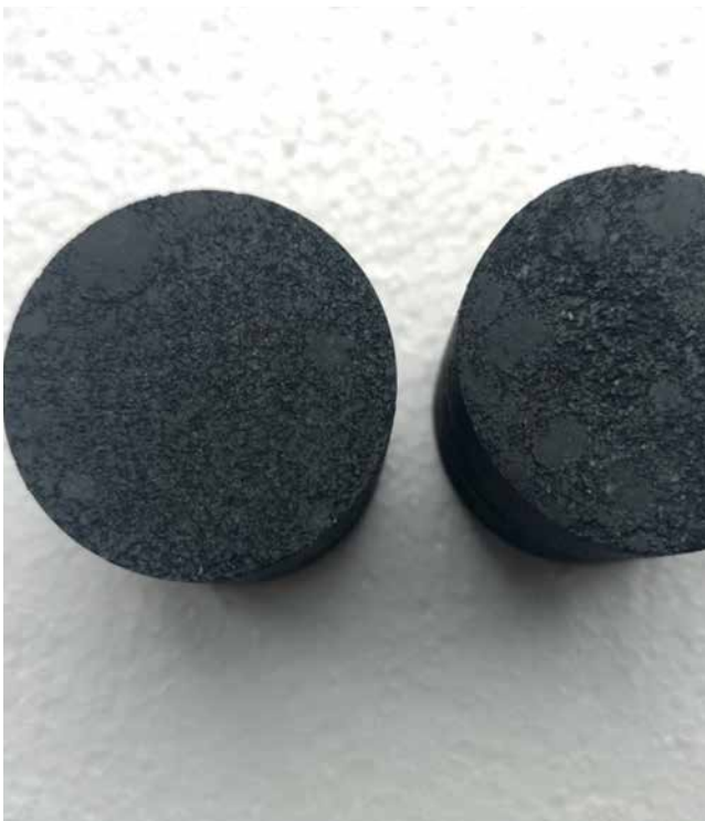
Anschliffe zur Untersuchung von Bindemittelverteilungen, Foto: CUTEK
