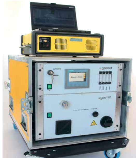
Bild 2: Einzusetzendes neuartiges FTIR der CUTEC (Prinzipbild), Foto: FTIR der Fa. Gasmet Technologies (Karlsruhe)
