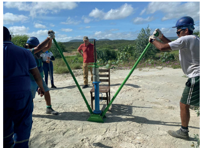
Bild 1: Rammkernsondierung der verschiedenen Haldenkörper, gemeinsame Projektarbeit von Mitarbeitern der Mineração Tomaz Salustino, des Geopark Seridó und des CUTEC-Forschungszentrums (Foto: CUTEC)
