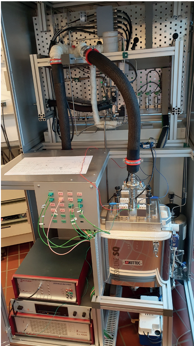
Bild 2: links: Hochtemperaturelektrolyse-Prüfstand für Einzelzellen (bis zu 125 mm), rechts: Teststand zur ortaufgelösten Untersuchung von katalytischen Gas-Feststoffreaktionen (Foto: CUTEC)
